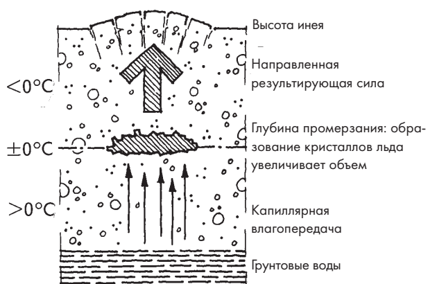
Рис. 31: Механизм роста инея.
