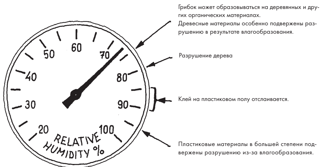
Рис.27 Результаты воздействия влажности
